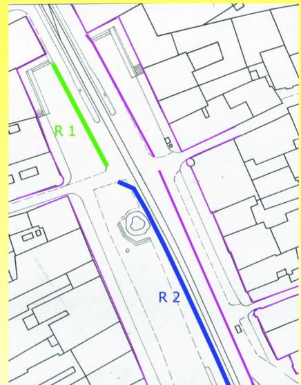
*Mit 2 optisch unauffälligen, mit ebenen Platten ausgebildeten Radstreifen (R1 und R2) könnte die Attraktivität der Nord-Süd-Querung des Linzer Hauptplatzes deutlich gesteigert werden.*
